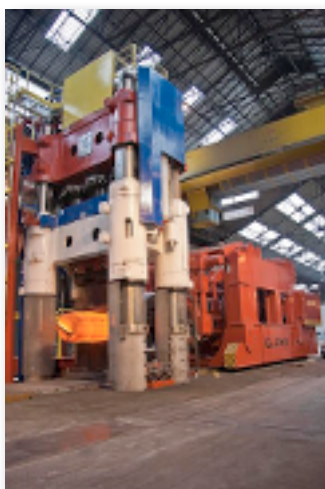
Un ensemble manipulateur-presse de 9.000 tonnes du site d'Areva du Creusot Forge.
